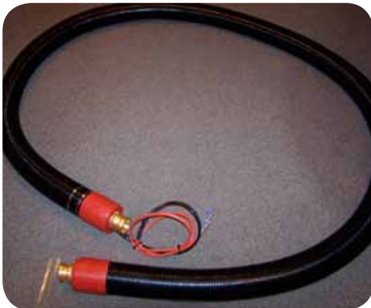
Walslang met verwarmingslint buiten de slang, voorzien van rode eindkap.
